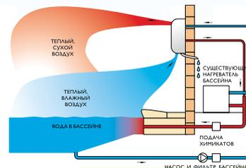
Осушители RH имеют дополнительный конденсатор, который подключается к системе циркуляции воды бассейна. Работа осушителей RH помогает поддерживать необходимый баланс между температурой воздуха и воды в помещении бассейна и позволяет уменьшить затраты энергии на нагрев воды за счет использования высвобождаемого при осушении тепла для подогрева воды бассейна.
