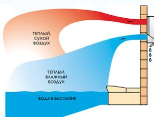
Осушители TTW предназначены для установки в смежном с бассейном техническом помещении. Такое расположение осушителя позволяет сохранить дизайн помещения бассейна, в котором устанавливаются только декоративные решетки забора и подачи воздуха.
