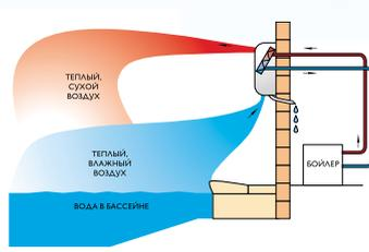
Осушители LPHW снабжены калорифером для нагрева воздуха горячей водой из системы теплоснабжения, что позволяет использовать осушитель для отопления помещения бассейна.
