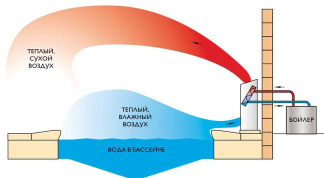
Осушители LPHW снабжены калорифером для нагрева воздуха горячей водой из системы теплоснабжения, что позволяет использовать осушитель для отопления помещения бассейна.
