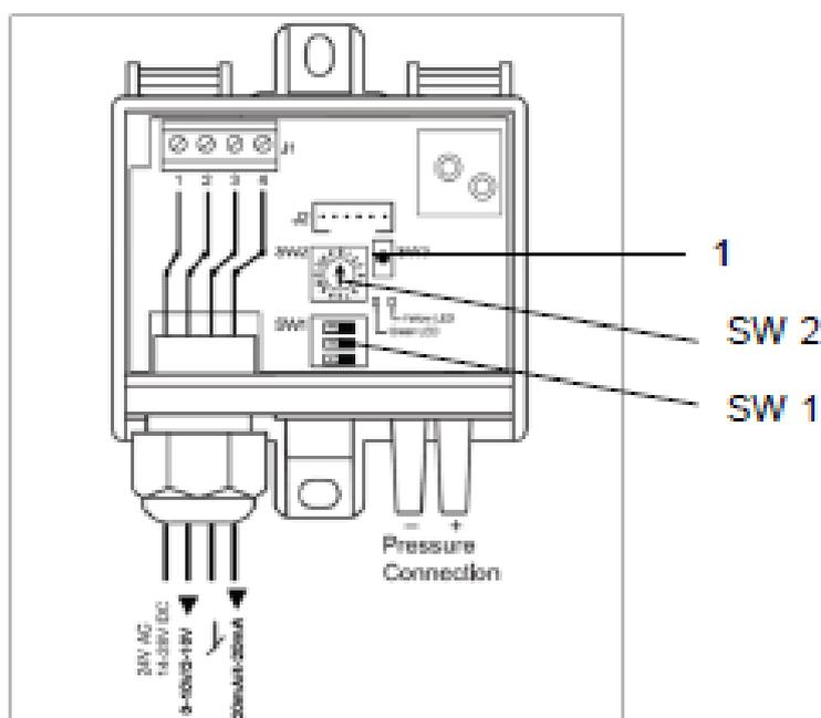
После установки агрегата и перед первым его запуском рекомендуется сбросить показания датчика на ноль. После подачи питания (горит зеленый светоиндикатор) нажмите кнопку установки нуля (1) и желтый светоиндикатор будет мигать в течение 3 секунд. После этого показания датчика давления сбрасываются.
