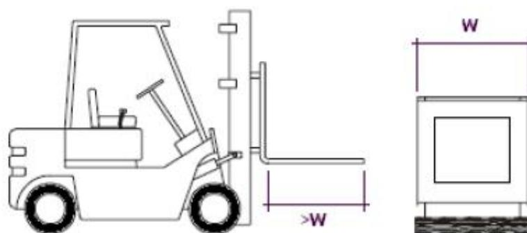
В зависимости от длины модуля существует два способа его подъема. Длинные модули с опорной рамой и деревянными траверсами или без опорной рамы на паллете всегда должны подниматься с инспекционной или тыльной стороны, и никогда не подниматься в продольном направлении, так как опорная рама или паллета не предназначены для этого.
