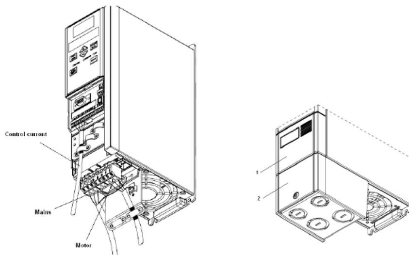
Если частотные преобразователи устанавливаются отдельно от агрегата DanX, все кабельное соединение должно осуществляться на месте в соответствии со схемой подключения и руководством для преобразователей, поставляемым с агрегатом DanX.
